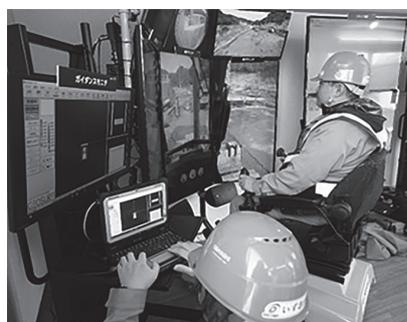
工事車両の遠隔操作の様子。「KDDI、大林組、NECが5Gで掘削、運搬、転圧など一連の道路造成工事の実証に成功」（KDDI報道資料）
