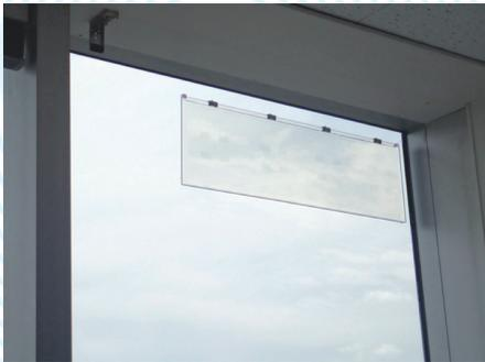
ガラスアンテナ。幅 84.3cm、長さ 18.5cmと小型で、窓ガラスに設置できる。
